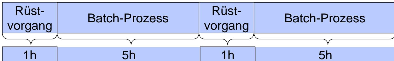
Kapazität = Einheiten pro Batch / Zykluszeit = (72 Einheiten pro Batch) / ((1+5)h pro Batch) = 12 Einheiten pro h
